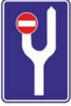
B-48 Bölünmüş Yol Öncesi Yön Levhası
