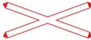
T-27a Kontrolsüz Demiryolu Geçidi (Tek Hat)
