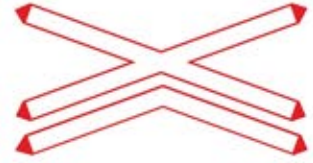
T-27b Kontrolsüz Demiryolu Geçidi (Çift Hat)
